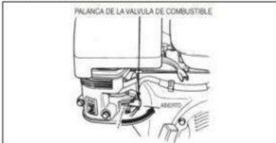
Fig 2. Palanca de cerrado de combustible
